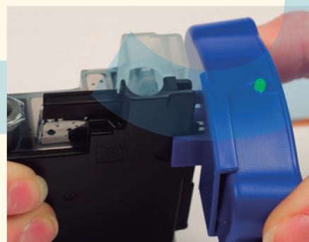
Paso 4: El chip ya se ha reseteado y el cartucho puede insertarse de nuevo en la impresora.
