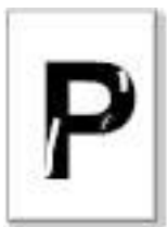
Falta de tóner
