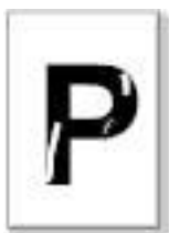
Falta de tóner
