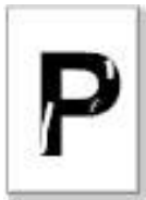
Falta de tóner
